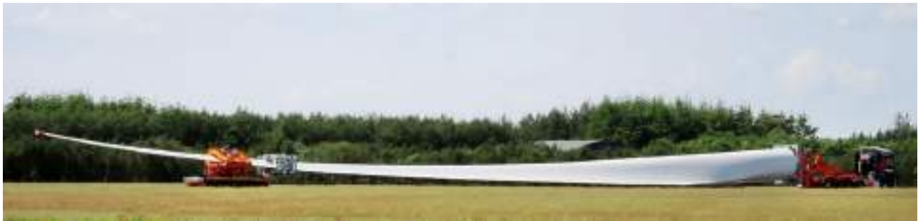
Figura 18 – Esempio di trasporto con “RBTS” (Rotor Blade Transport System)
