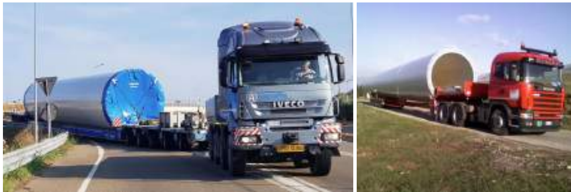
Figura 19 – Esempio di trasporto con convogli a pianale allungabile per conchi di torre
