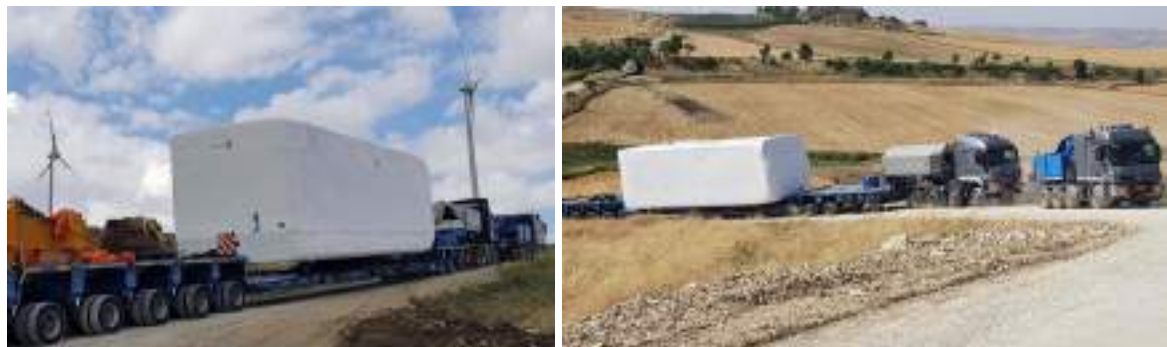
Figura 20 – Esempio di trasporto “Navicella”
